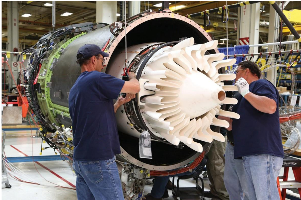
รูปที่ 4.2-1 การนำเซรามิกมาใช้เป็นส่วนประกอบของเครื่องยนต์ที่ใช้ในอากาศยาน
