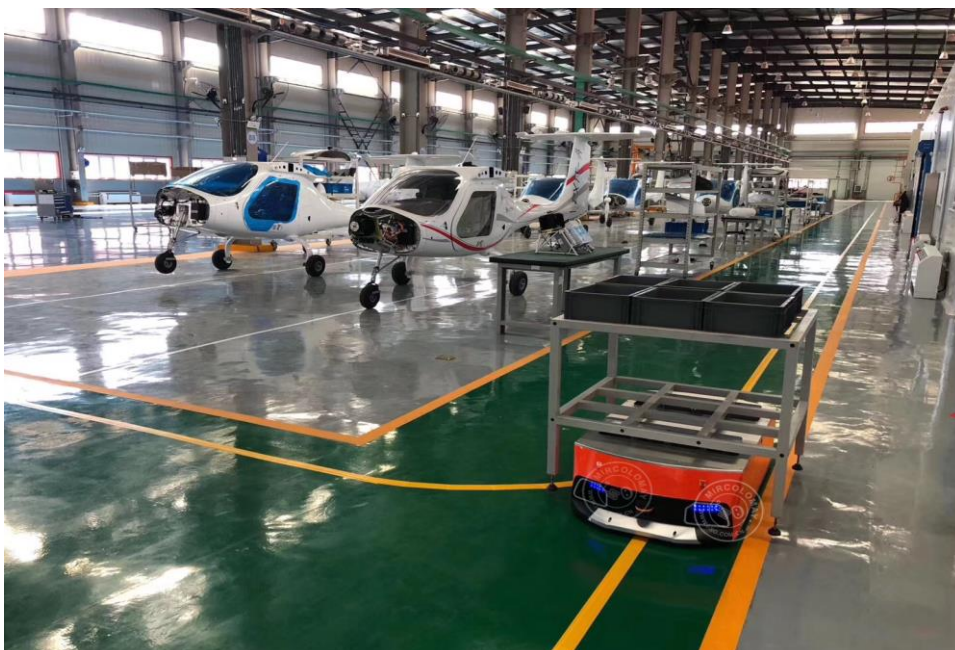
รูปที่ 4.2-4 การนำ AGV มาใช้ในการผลิตและซ่อมอากาศยาน
