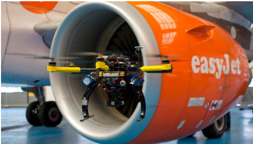
รูปที่ 4.2-3 การนำระบบอัตโนมัติและเทคโนโลยีหุ่นยนต์มาใช้ในการซ่อมบำรุงอากาศยาน
