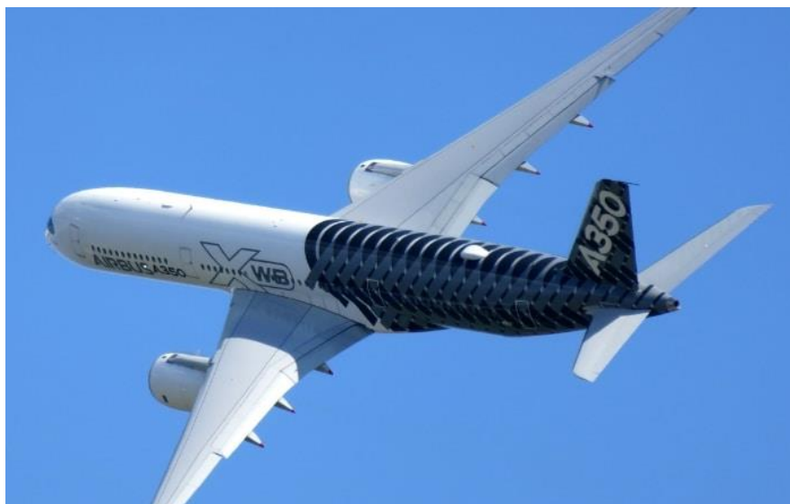
รูปที่ 4.2-2 การนำคาร์บอนไฟเบอร์มาใช้ผลิตเครื่องบินเพื่อลดน้ำหนักรวมของเครื่องบิน
